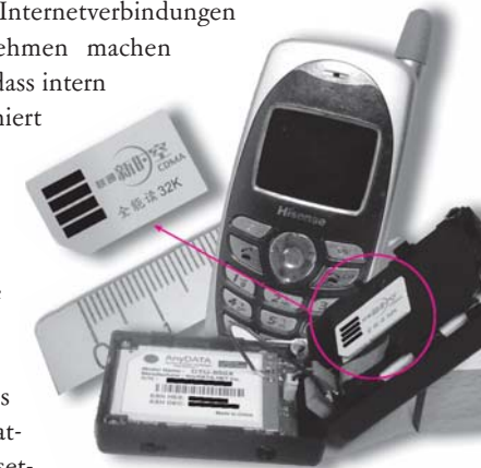
Handy-gesteuerte „Abhörwanze“ (aufgefunden im Büro einer deutschen Firma in China)
